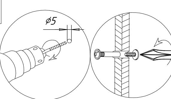
Стеллажи можно соединять между собой при помощи межсекционных стяжек. Для этого необходимо просверлить отверстия  $\phi 5$  мм в соседних стенках, предварительно выровняв изделия.
