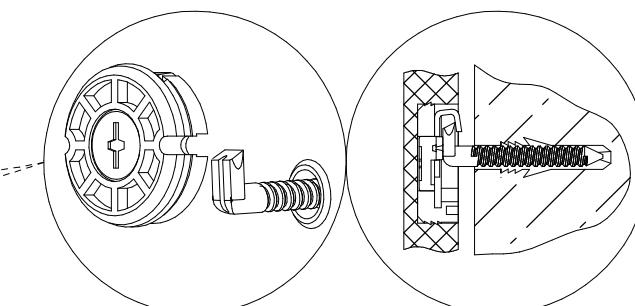
Поворачивая эксцентрики на подвесках по или против часовой стрелки, выровнять изделие по высоте.
