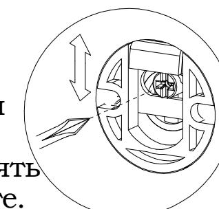
Находящаяся в комплекте фурнитура для крепления к стене предназначена исключительно для применения в прочной кладке. В случае, если стены сделаны из другого материала, как, например, стены с применением облегчённых конструкций, необходимо использовать подходящую для них фурнитуру.
