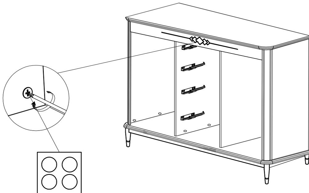
Укладываем на чистую и ровную поверхность тумбу крышкой вниз и крепим к ней опорную часть на винты-саморезы. Клеим на опоры подкладки. Устанавливаем тумбу в вертикальное положение.
